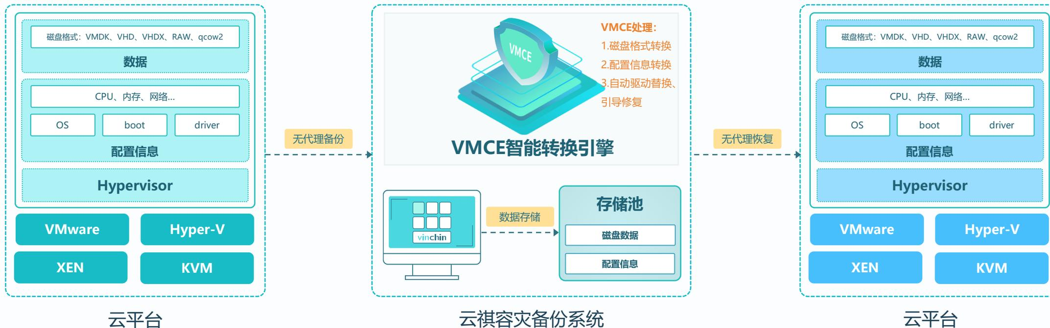
VMCE转换引擎，将获取到的云平台虚拟机配置信息、磁盘格式、硬件与驱动信息等转换为目标云平台支持的格式，自动替换驱动，自动进行引导修复，提高虚拟化平台之间的转换效率，满足跨平台虚拟机迁移的业务需求。
